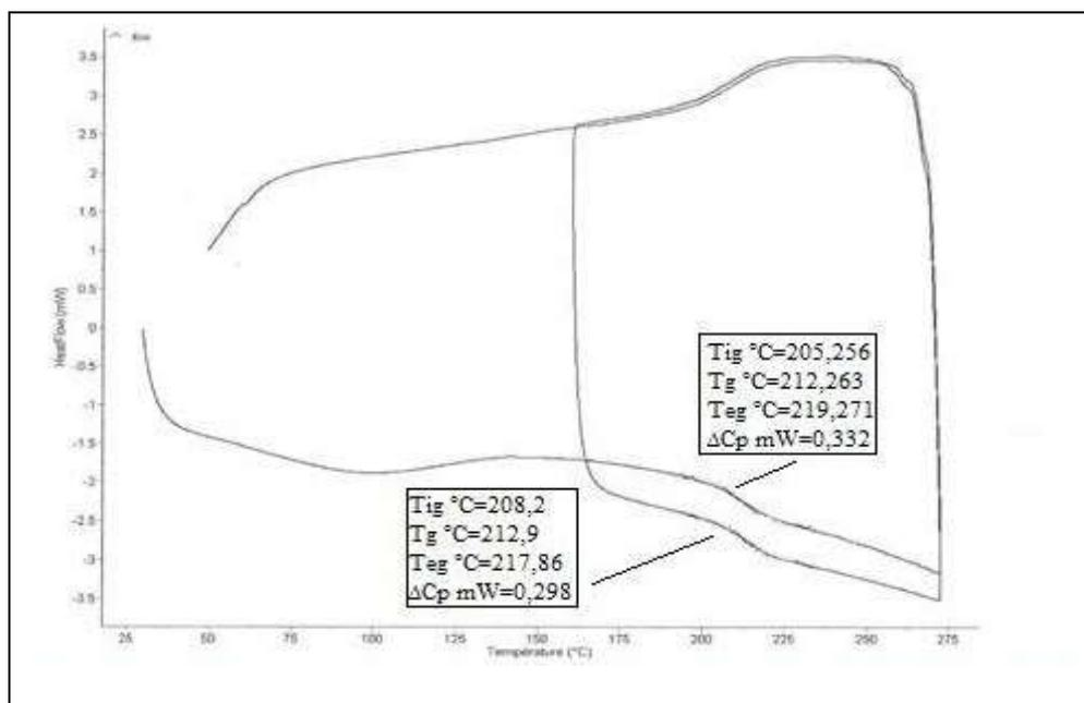
**Fig 3:** DSC spectra of  $CP_3(X_3:COCH_3)$ .
